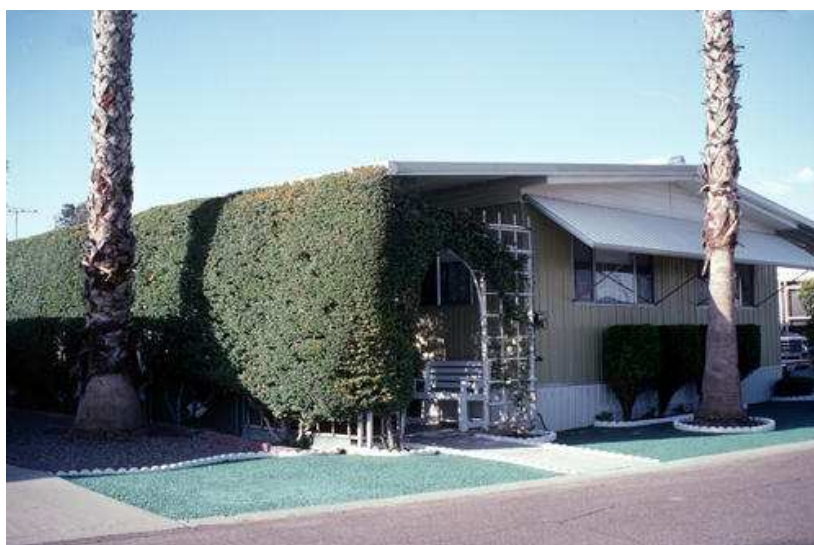
Σχήμα 1.5. Παράδειγμα προστασίας όψης κτιρίου από την παρουσία επιφάνειας πυκνής φύτευσης με αναρριχητικά φυτά
